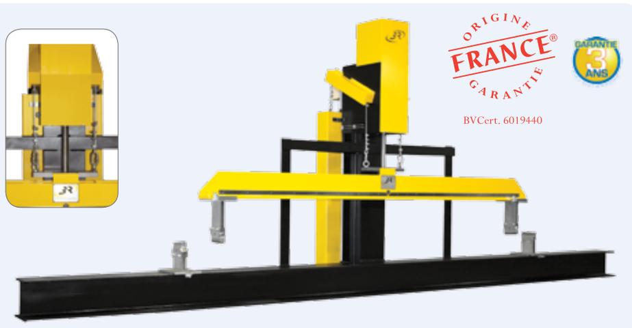
Destinée aux usines de production de poutrelles précontraintes ou en béton armé, nos presses permettent à un opérateur seul de réaliser ses différents essais en mode automatique, y compris les différents paliers, ainsi que les mesures de flèche exigés par la norme EN 15037-1.
